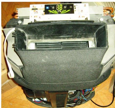
**A gauche; la sonde de température placée, sur la grille d'extraction d'air chaud.**
