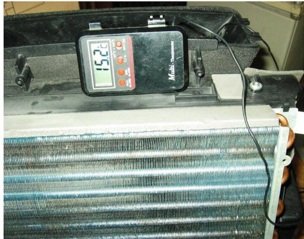
La sonde du thermomètre est placée en sortie de l'évaporateur.
