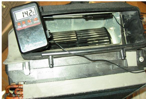
La grille de soufflage retirée, on aperçoit dans son logement, le ventilateur tangentiel de l'évaporateur.
