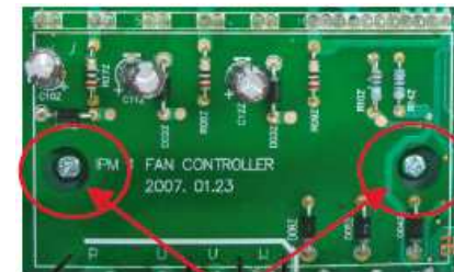
IPM - Contrôle des conditions d'assemblage
