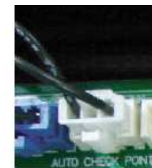
Sonde radiateur - Contrôle des conditions d'assemblage et connexion
