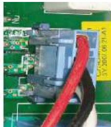
Câblage - Contrôle état de connexion moteurs ventilateurs
